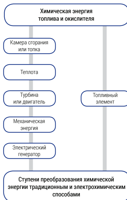
Рис. 2. Ступени преобразования химической энергии традиционным и электрохимическим способами
