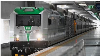
Шестиосный локомотив, изготовленный на предприятии CRRC в Дальяне, способен обеспечить тягу грузового поезда массой 2500 т со скоростью 70 км/ч или пассажирского поезда массой 1000 т со скоростью 100 км/ч.
