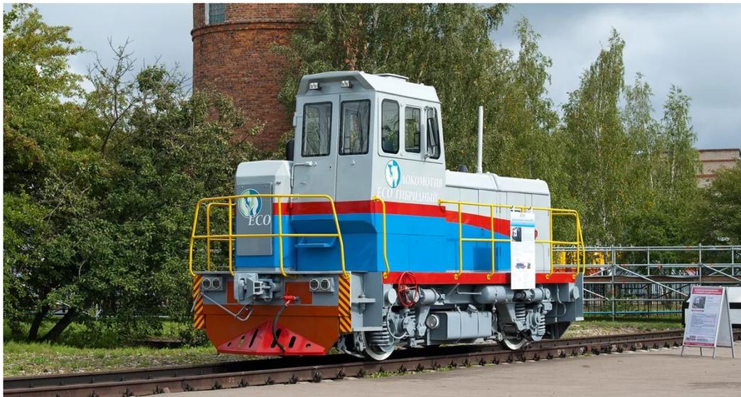
**ЛГМ1** — маневровый тепловоз с гибридной тягой от аккумулятора и дизельного двигателя. Способствует экономии расхода топлива на 40% и вредных выбросов в атмосферу. Предназначен для выполнения лёгких маневровых и хозяйственных работ на путях колеи 1520 мм промышленных предприятий и железнодорожных станций. Разработан и изготовлен НПП «Полёт» (г. Обнинск Калужской обл.).
