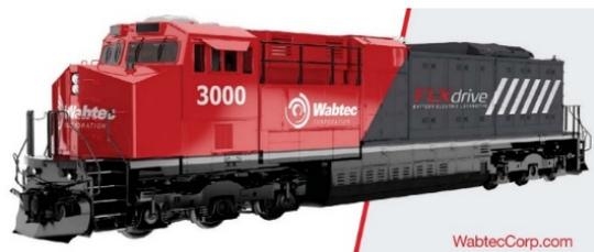
При тяги тяжеловесных поездов совместно с двумя тепловозами позволяет снизить расходы топлива и выбросы углекислого газа на 11%. Для дальнейшего снижения расхода топлива и выбросов CO<sub>2</sub> компания намерена увеличивать мощность следующей версии локомотива на аккумуляторах до 6МВт, а также применять систему топливных элементов на водороде HYDROTEC в замен дизельных установок.
