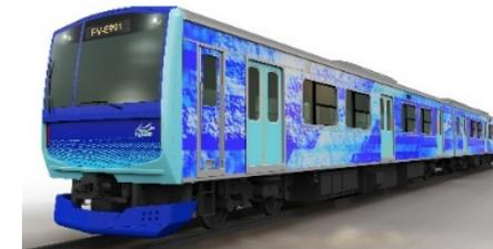
Питание тяговых двигателей будет осуществляться от блока литий-ионных аккумуляторов емкостью 2×120 кВт·ч и батареи водородных топливных элементов с твердым полимерным электролитом мощностью 4×60 кВт.
