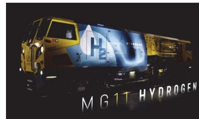
Запаса водорода достаточно для функционирования машины в течение одной смены и следования к месту выполнения работ и обратно. Переход к установке топливных элементов вместо дизеля в сочетании с внедренной компанией Linsinger технологией фрезерования рельсов, при использовании которой не возникают искры и пыль, а также с отлаженной системой сбора и рециклинга образующихся отходов, позволяет минимизировать неблагоприятное воздействие этого процесса на окружающую среду
