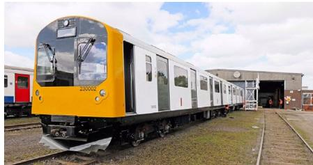
Компания Vivarail, специализирующаяся на аккумуляторных технологиях для железнодорожного транспорта, представила электропоезд второго поколения с нулевым уровнем вредных выбросов. Это один из самых высокоэффективных поездов в мире. На зарядку требуется всего 10 минут, запас хода – до 130 км.
