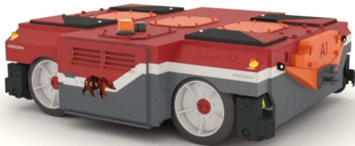
ЭМТМ предназначена для выполнения маневровых работ на путях необщего пользования - транспортирование рельсового подвижного состава (тягового и несамоходного), а также тяжелых грузов по цеховым и межцеховым транспортным железнодорожным путям предприятия, в том числе выполнение маневровых работ на трансбордере и поворотном круге.
