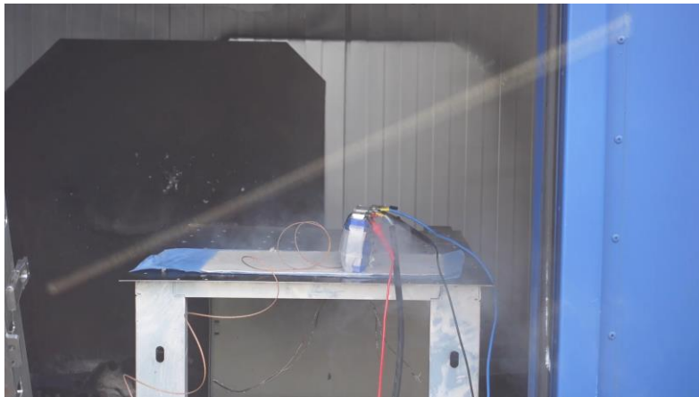
Литий-титанатный аккумулятор 33Ач Принудительный перезаряд аккумулятора
