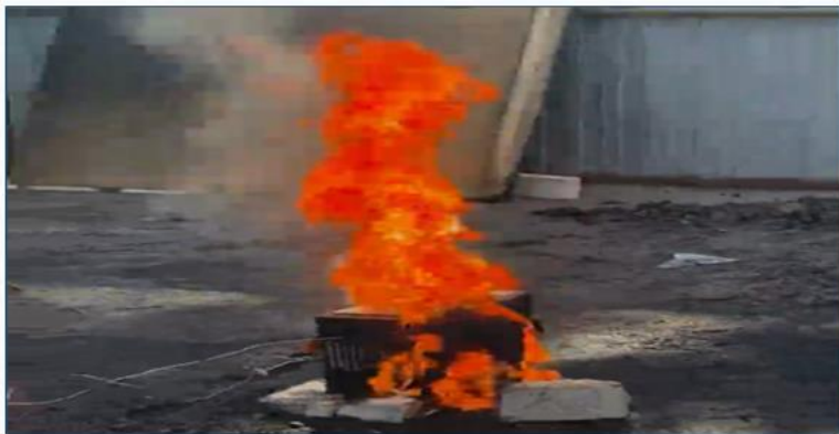
Возгорание единичного аккумулятора (внешний нагрев)
