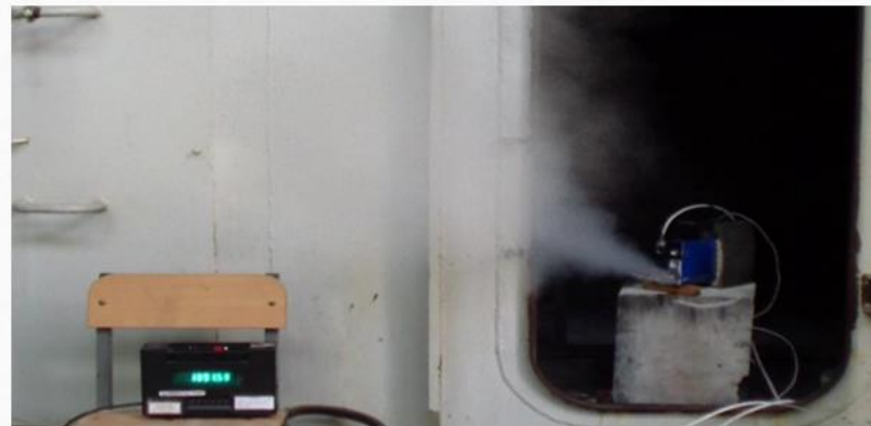
Выделение газовой фазы из аккумуляторной ячейки (перезаряд)
