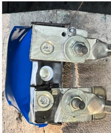
Вздутие корпуса аккумуляторной ячейки после теплового разгона в результате короткого замыкания
