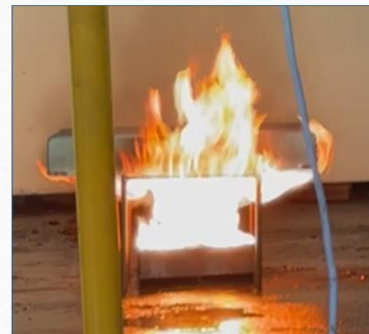
Тепловой разгон батарейного модуля (модельный очаг пожара)
