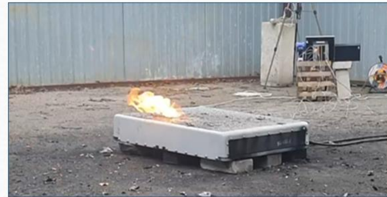
Тепловой разгон единичного аккумулятора в составе батарейного модуля (перезаряд)
