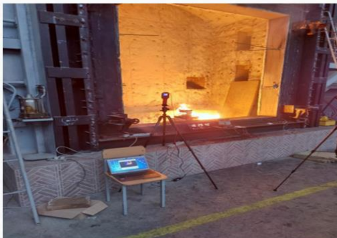
Тепловой разгон единичного аккумулятора в составе батарейного модуля (перезаряд)
