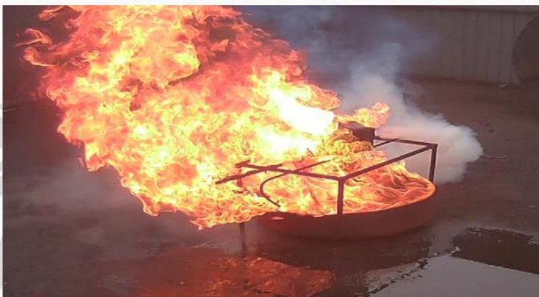
Терморазгон аккумуляторных ячеек в составе блока от пламени бензина с горением продуктов терморазгона
