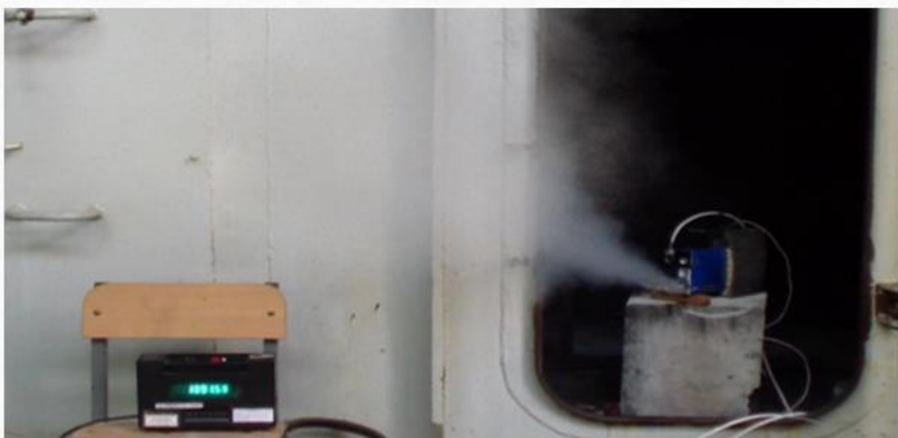
Тепловой разгон аккумуляторной ячейки в результате перезаряда током 30,55 А
