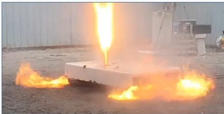
Тепловой разгон единичного аккумулятора в составе батарейного модуля (перезаряд)
