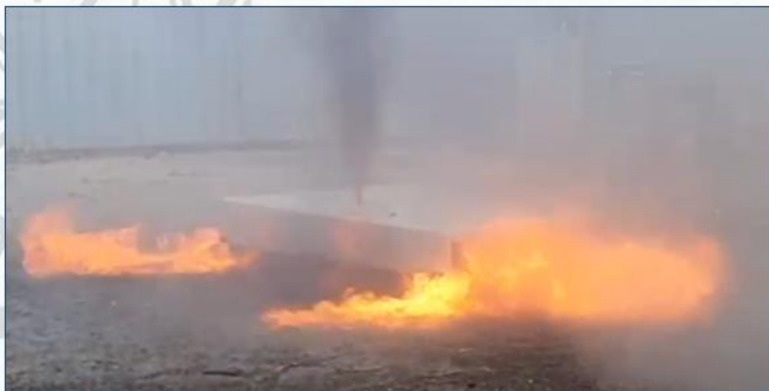
Тепловой разгон единичного аккумулятора в составе батарейного модуля (перезаряд)
