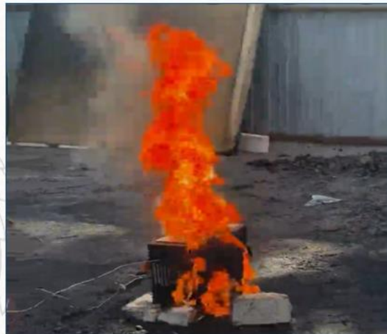
Тепловой разгон единичного аккумулятора в составе батарейного модуля (перезаряд)
