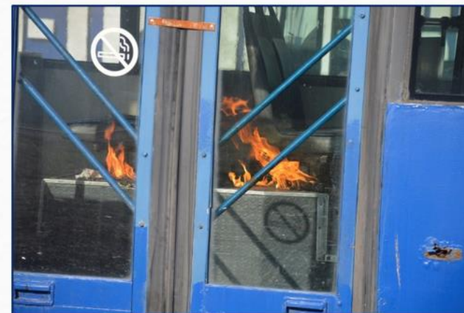
Горение ЛИА при размещении на крыше троллейбуса
