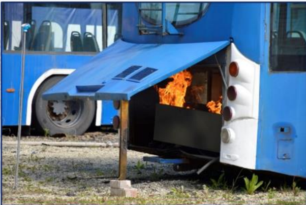
Горение ЛИА при размещении в заднем отсеке троллейбуса
