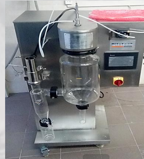
Распылительная сушилка на стадии синтеза катодов ЛИА
