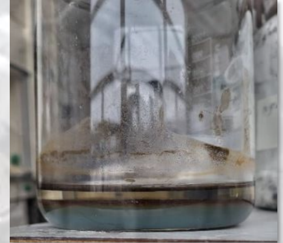
Раствор в конце цикла осаждения, содержащий \text{Co(OH)}_2 (осадок) \text{(Li}_2\text{SO}_4\text{)} (раствор), из которого получают LiOH
