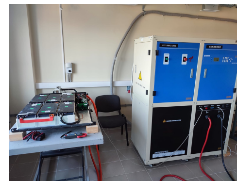
ФТИ им. Иоффе Испытания системы управления на перезаряд
