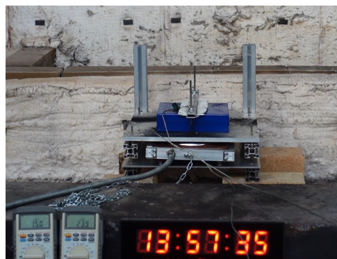
ВНИПО Испытания на устойчивость к перегреву аккумулятора блока «САЭ»
