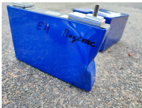
ФТИ им. Иоффе Испытания на устойчивость к деформации аккумулятора блока «САЭ»
