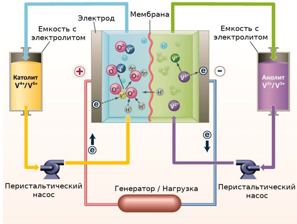
Рис. 2. Принцип работы ванадиевой проточной редокс-батареи.
